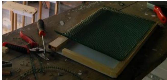
Imatge 9. Calaix adaptat per recollir els glomèruls de pol·len (Castro, J. 2019)
