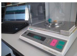
Imatge 15. Balança molt precisa de la UdG (Castro, J. 2019)
